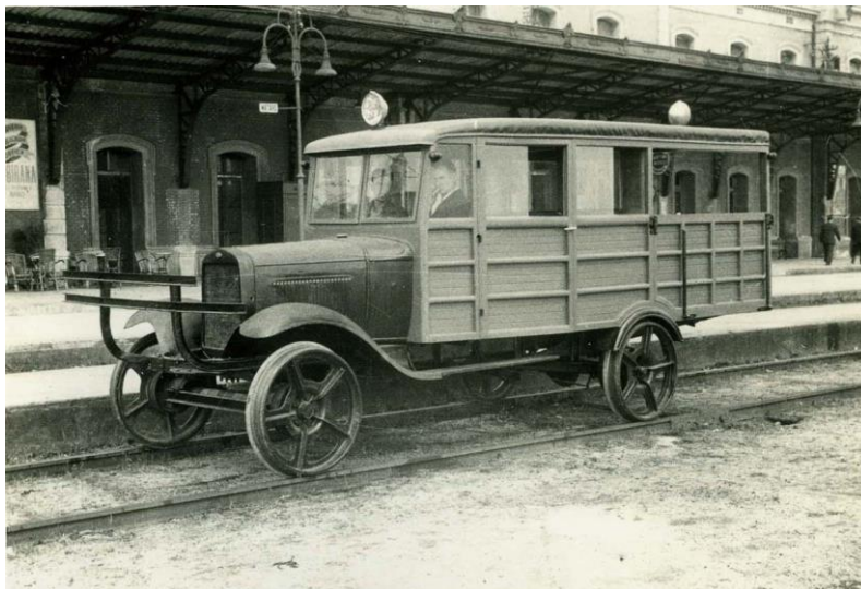
Ilustración 4: Vagoneta automotora de electrificación, para reconocimiento de la catenaria. Motor Ford de 17 HP
